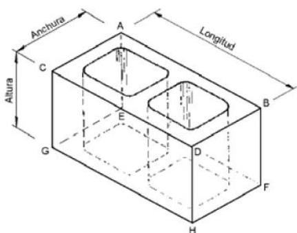
La norma UNE 127771-3, complemento nacional a la norma europea de bloques, los define como una pieza prefabricada a base de cemento, agua y áridos finos y/o gruesos, naturales y/o artificiales, con o sin adiciones y aditivos, incluidos pigmentos, de forma sensiblemente ortoédrica, con una relación altura/anchura inferior a 6, y altura/longitud inferior a 1, sin armadura alguna y con una densidad seca absoluta que suele estar comprendida entre  $1.700 \text{ kg/m}^3$  y  $2.400 \text{ kg/m}^3$ .
