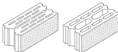
Piezas especiales: bloques de esquina, medio bloques, plaqueta, bloques en "U" para crear zunchos o vigas de hormigón armado, bloque de encuentro para mantener el aparejo en determinados muros, bloque pilastra de enlace, bloque pilastra sencilla,...
