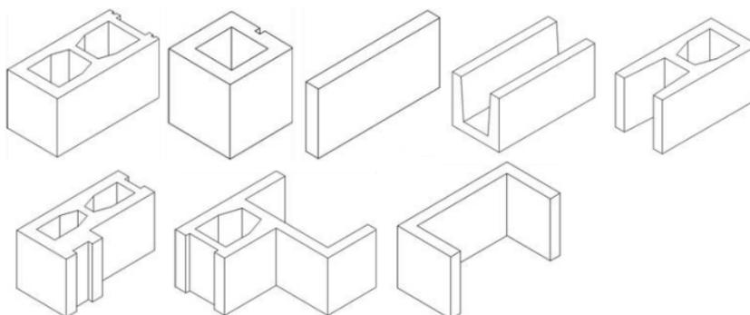
Piezas de fábrica para muros de contención
